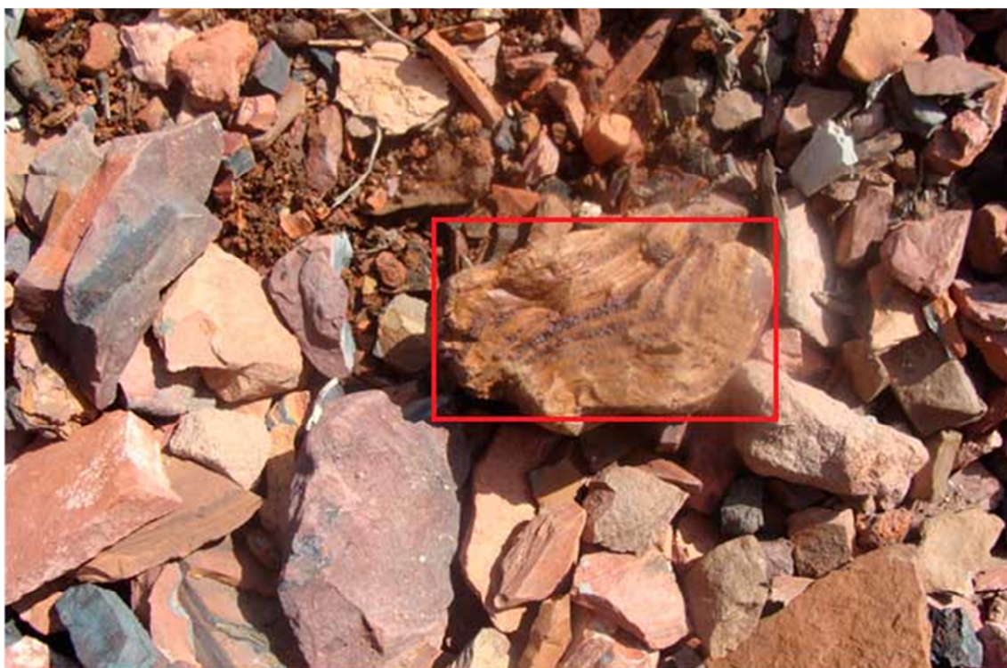
Рисунок 1 – Отвал ш. Путиловская [5]. В образце аргиллита отчетливо проявлено послойное плавление. Продукты плавления в виде пористого шлакообразного материала
