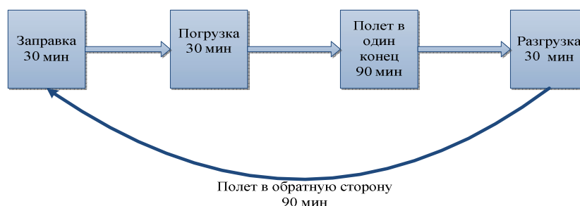
Рис. 2. Временная схема доставки буровой установки
